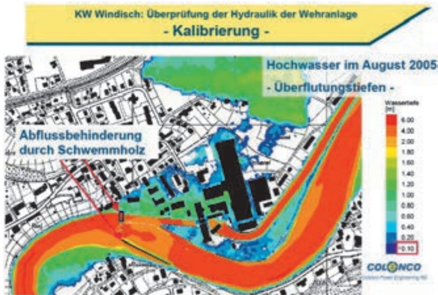
Die Hydraulik der Wehranlage Windisch wurde mit einem zweidimensionalen Modell überprüft.
